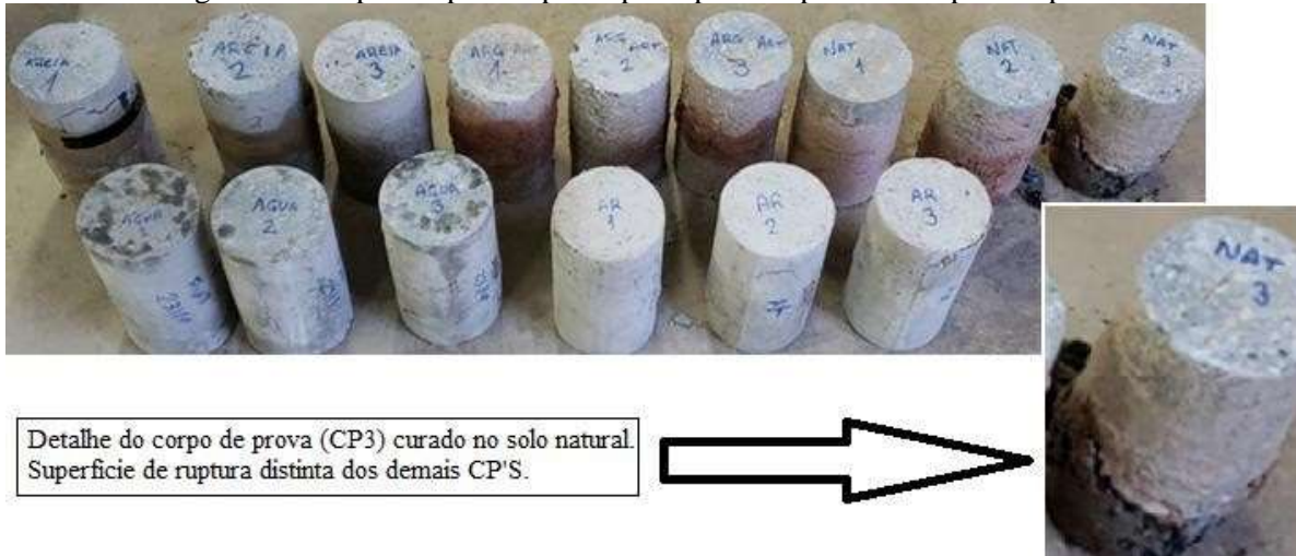
Figura 8 – Corpos de prova após ruptura por compressão simples na prensa.
