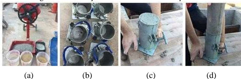
Figura 2 – Fabricação dos CP's curados no tanque e ao ar.
