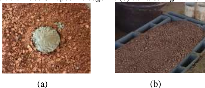
Figura 4 – (a) Detalhe de um dos CP após moldagem e (b) caixa de argila/silte com CP's já enterrados
