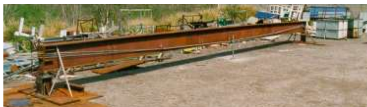
Figura 1 – Viga metálica protendida com traçado poligonal
