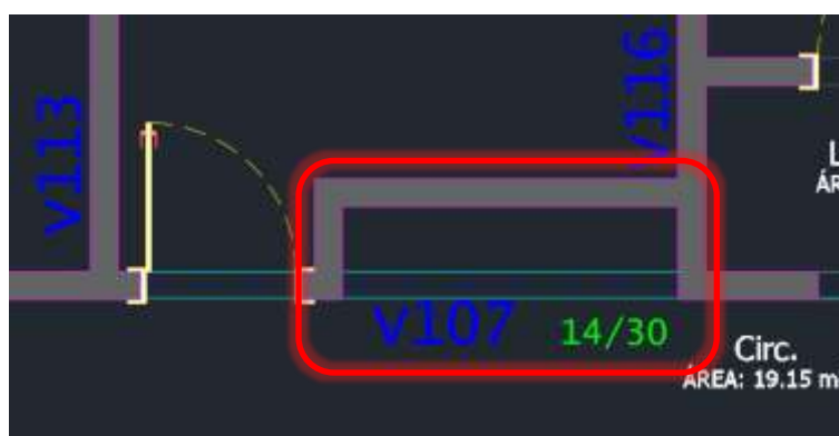
Figura 7 - Sobreposição entre projetos estrutural e arquitetônico
