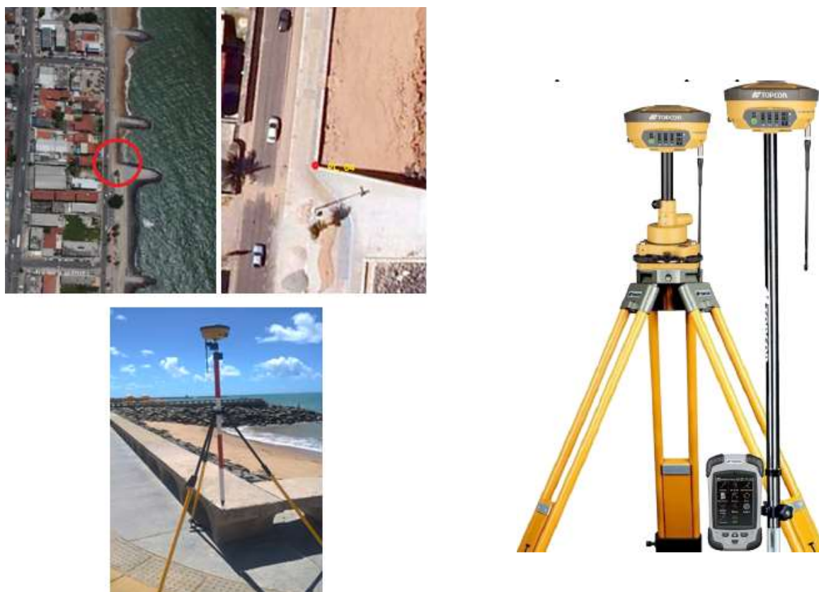
Figura 4 - A esquerda, definição de pontos visíveis nas imagens e rastreo GNSS, A direita, Receptor GNSS Topcon Hiper Lite II.
