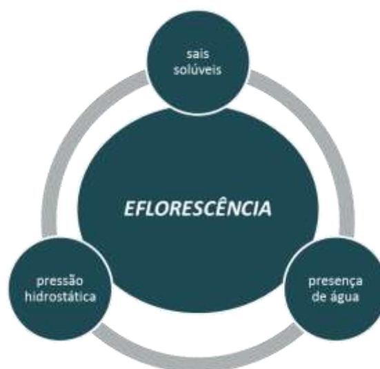
Figura 5 – Fatores necessários para a ocorrência da eflorescência
